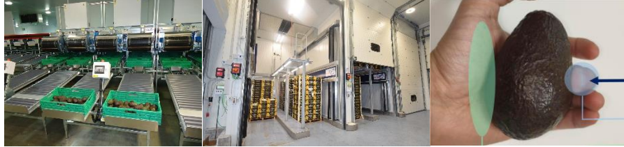
Fig. 2. (1) Procesos de clasificación y paletización semiautomáticos, (2) cámara de maduración para aguacates, (3) mecanismo de medición manual de madurez del aguacate.
